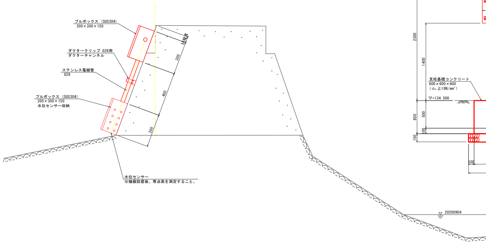
水位センサー取付部断面図 S=1/10
